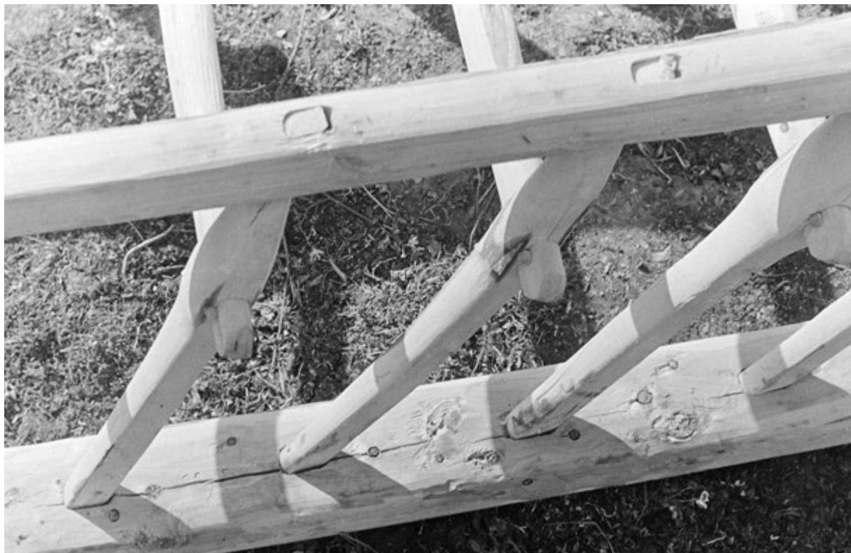
Копылья нарт крупным планом. Шиповые соединения
